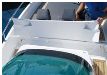
▲ Nevidljiva tenda Sklopanjem tende u spremište pred konzolom ona u tren oka postaje nevidljiva
