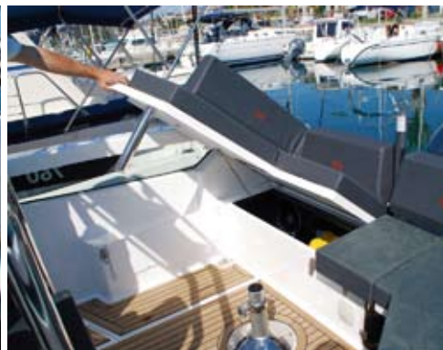
▲ Krmeno spremište Podizanjem dijela krmene klupe dolazi se do krmenoga spremišta, najvećeg spremišta na brodići
