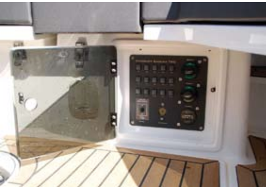
▲ Malo neobično ali funkcionalno, umjesto u kabini glavna ploča s osiguračima smještena je u krmenom dijelu kokpita
