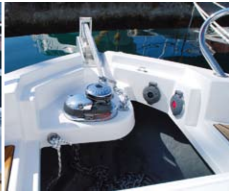
▲ Sidreno vitlo ugrađeno je pod poklopac spremišta i tako sklonjeno od pogleda i od nesprenih nogu koje ovako ne mogu zapeti za njega
