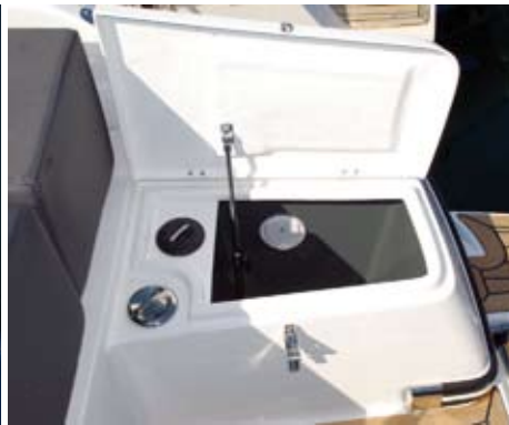
▲ Skriveno od pogleda Čepovi za gorivo i vodu, kao i krmeni tuš smješteni su u jednom od krmernih spremišta
